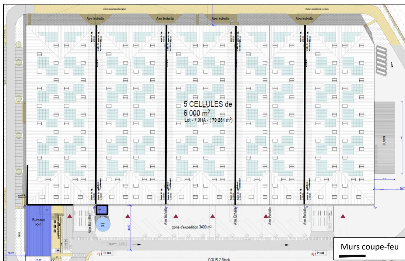
Figure 15 : Localisation des zones recoupées par des murs coupe-feu (source plan : SOHA ATLAS IN FINE)
